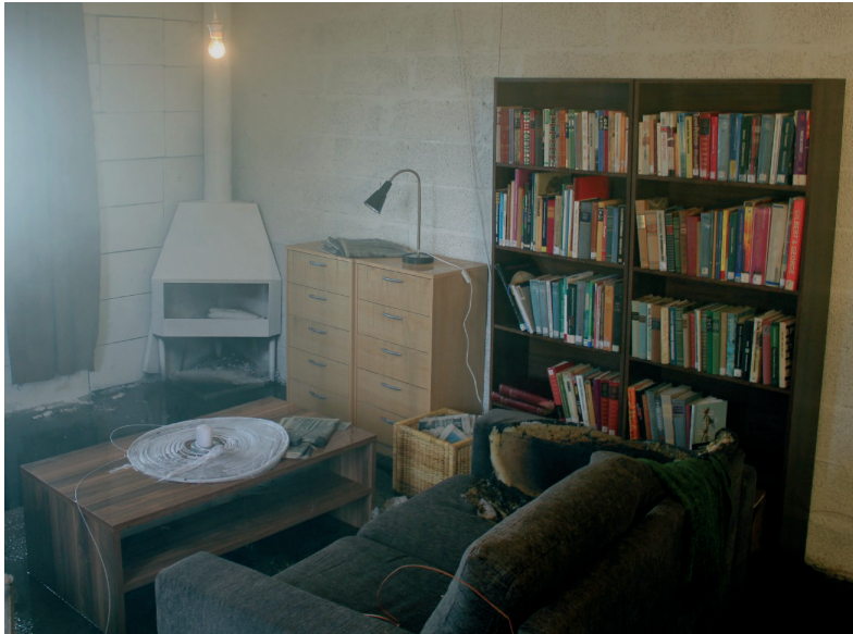
Kuva 5. Automaattisella sammutuslaitteistolla suojattu huoneisto VTT:n Pelastusopistolla tekemien polttokokeiden jälkeen. Huoneiston sohva syttyi tupakasta palamaan. Koejärjestelyt vastasivat aiemmin kuvassa 2 esitettyä polttokoetta, joka tehtiin ilman automaattista sammutuslaitteistoa. Pelastuslaitoksen sammutustoiminta aloitettiin tässäkin tapauksessa 18 minuutin kuluttua syttymästä, vaikka hälytys saadaan suojatuissa kohteissa usein aiemmin kuin suojaamattomissa kohteissa. Vahingot muodostuvat yleensä huomattavasti pienemmiksi, kun tila on suojattu automaattisella sammutuslaitteistolla. Tämä todettiin myös polttokokeissa, eivätkä olosuhteet muuttuneet missään vaiheessa ihmiselle hengenvaarallisiksi.
